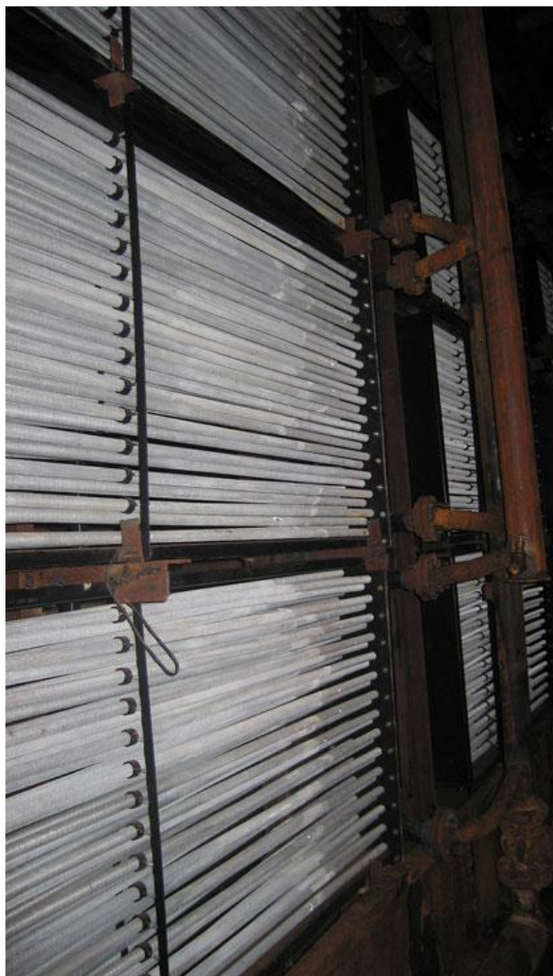
Рис.10.9. Расположение алюминиевого калорифера КТР-А в выработке
