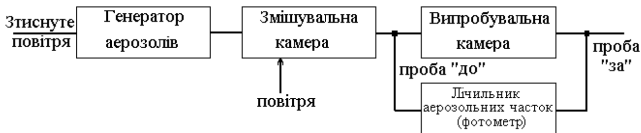
Рис. 11. Принципова схема установки по визначенню коефіцієнта проникнення за тест-аерозолем масляного туману
